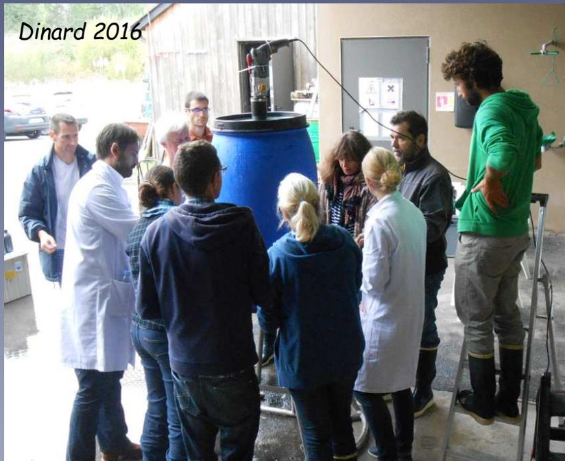
Exercice d'intercomparaison : prélèvements de la fraction particulaire à partir d'un bidon de 200 litres adapté pour un mélange continu.
